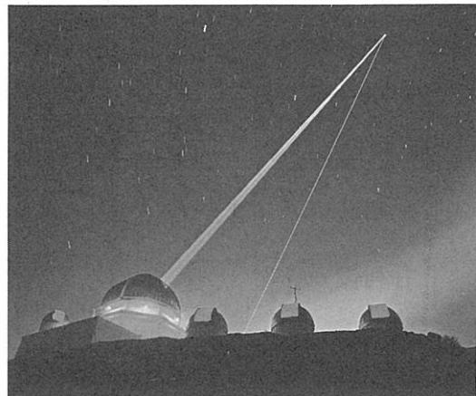
図4 レーザーガイド星生成実験。アメリカのStarfire Optical Rangeでの実験のようす。左側の太いビームはYAGレーザー、右側の細いビームはナトリウムレーザー。大気中のほこりや分子による散乱のため途中のビームがみえている。(Roger Ressmeyer/© Corbis)
